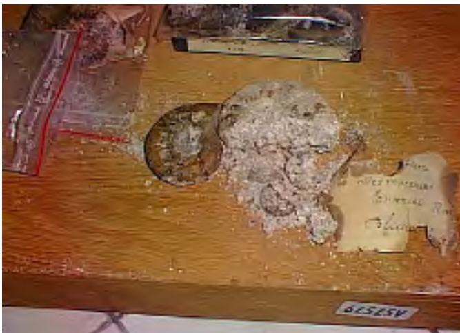
Figure 1. Ammonites pyriteuses décomposées par l'humidité.
