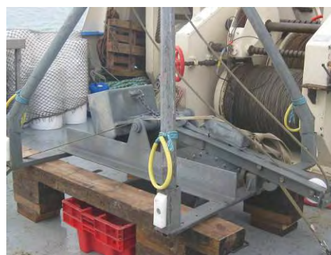
Benne Hamon en position armée sur le pont (source : CREOCEAN)
