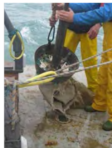
Drague Rallier du Baty ramenée sur le pont (source : CREOCEAN)
