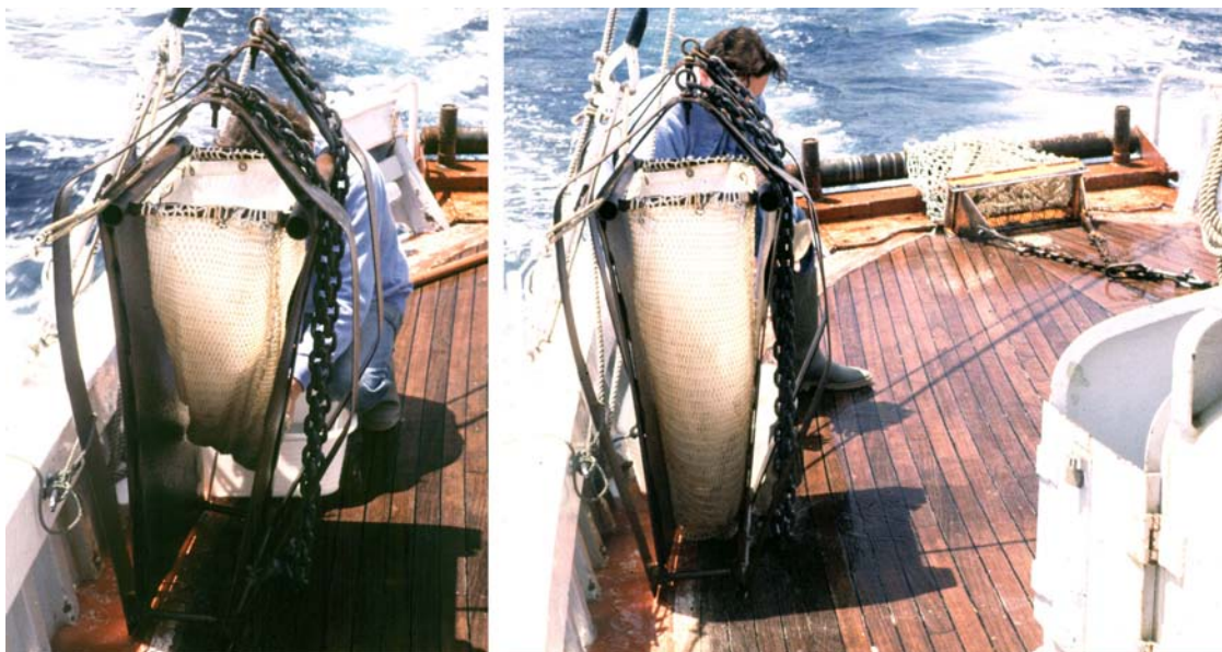
Fig. 2-5. Luge épibenthique en cours de recueillement du prélèvement (à gauche) et prête pour la prochaine mise à l'eau.
