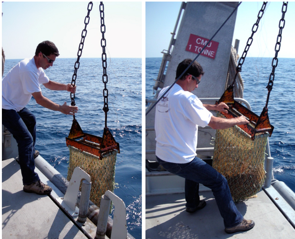
Fig. 2-2. Retour sur le pont d'une drague Charcot-Picard sans caleçon (Photos extraites d'une vidéo).
