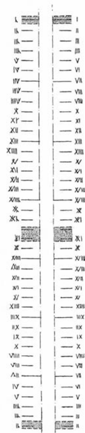
Figure 3 – Plan schématique des marques d'assemblage de la deuxième à la huitième travée de la nef de l'église Saint-Nicolas-des-Champs, à Paris (d'après P. Hoffsummer, dir., Les charpentes du XI e au XIX e siècle ).
