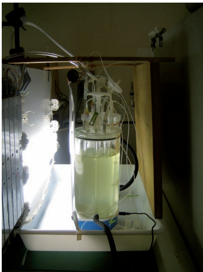
FIG. 5. – Photobioréacteur du programme de recherche Shamash du laboratoire océanographique de Villefranche-sur-Mer, 2009 (© S. Litzler).
