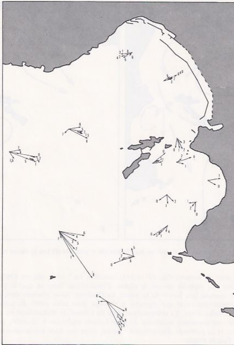
Figure 15 – Résultats de mesures de courant effectuées par régime de temps calme. La profondeur est exprimée en dizaine de mètres à l'extrémité de chaque vecteur et la vitesse est proportionnelle à la longueur du vecteur (0,66 cm = 10 cm/s).
