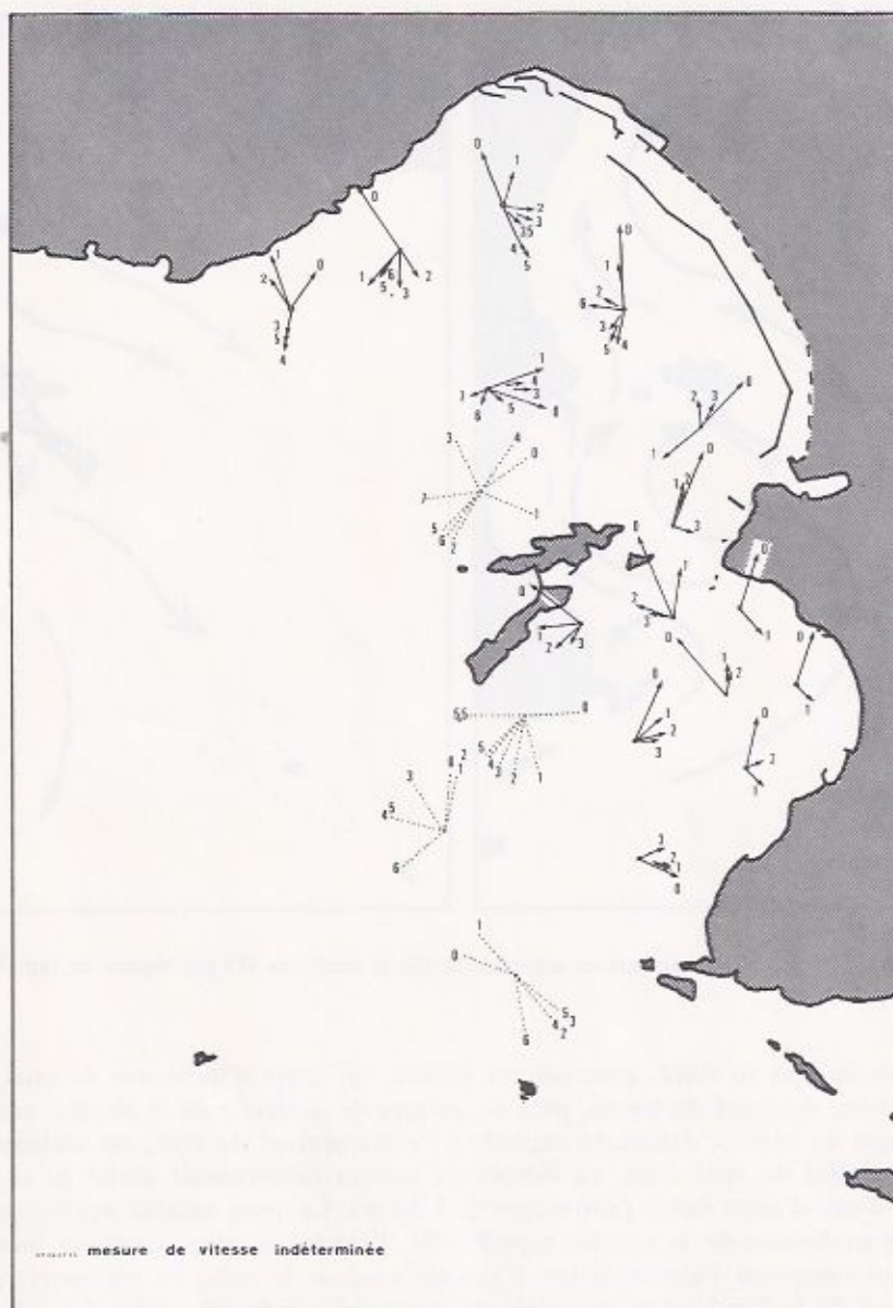
Figure 24 — Résultats des mesures de courant effectuées par régime de vent d'est. La profondeur est exprimée en dizaine de mètres à l'extrémité de chaque vecteur et la vitesse est proportionnelle à la longueur du vecteur (0,66 cm = 10 cm/s).
